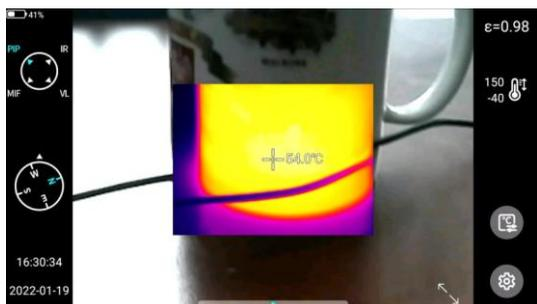
**PIP** – imagen-en-imagen - se visualiza la imagen visible y la imagen térmica.
